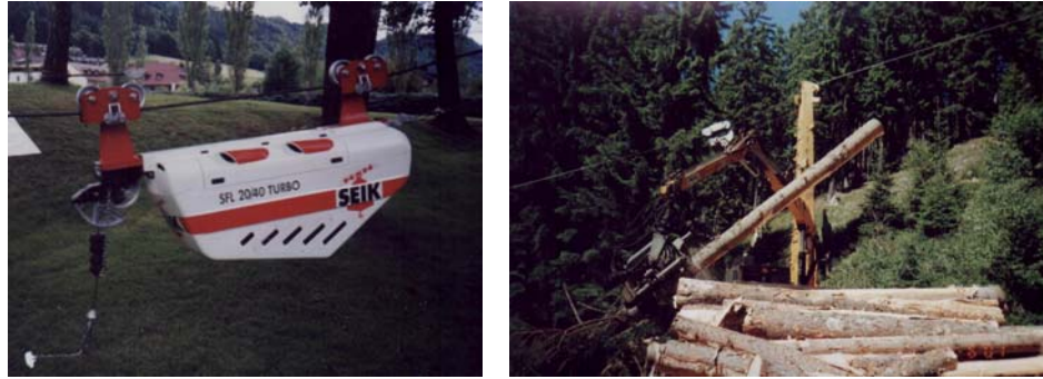
Şekil 1: Uzaktan kumandalı hava hatları ve prosesörler- Avusturya (Foto: T.Öztürk)
