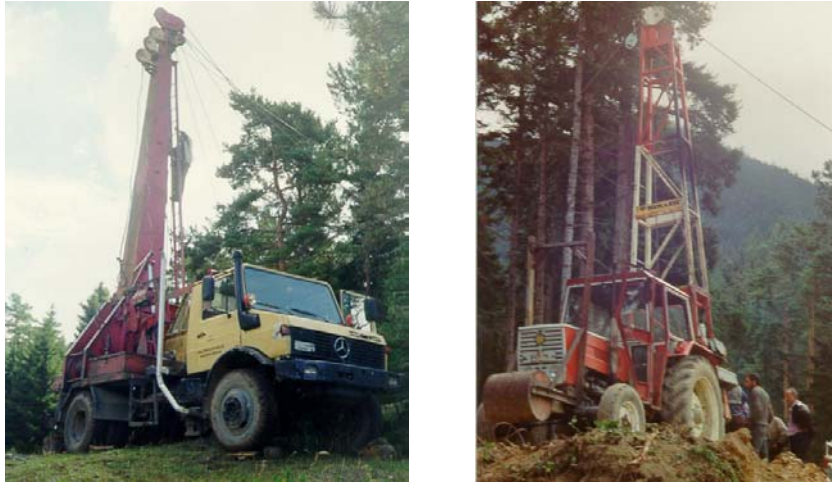
Şekil 2: Ülkemizde kullanılan URUS MIII ve Koller K300 hava hatları - Artvin (Foto: T.Öztürk)
